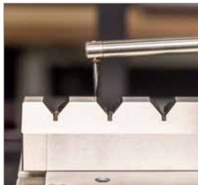
Längenmessabweichung der X-Achse eines Konturmessgeräts
