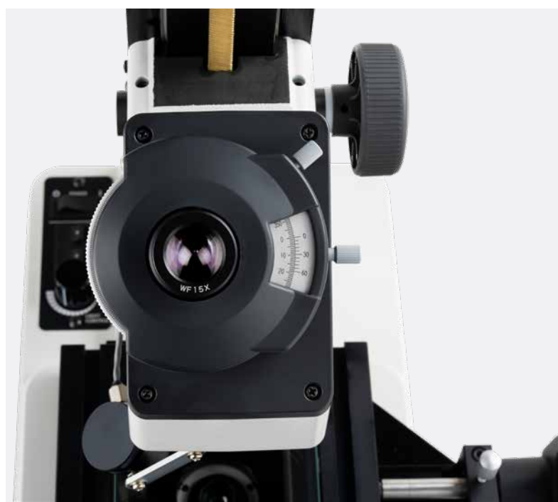
Eine am äusseren Rand des Okulars angebrachte Nonius-Skala ermöglicht eine einfache Winkelmessung.
