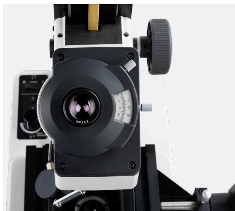
Un vernier monté à l'extérieur de l'oculaire facilite les mesures angulaires.
