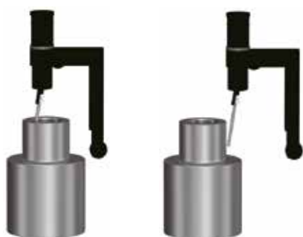
Funzione di diametro interno ed esterno continuo (superficie del diametro interno)
