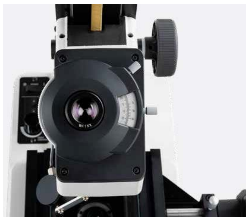
Una scala a nonio montata all'esterno dell'oculare consente una semplice misura dell'angolo.
