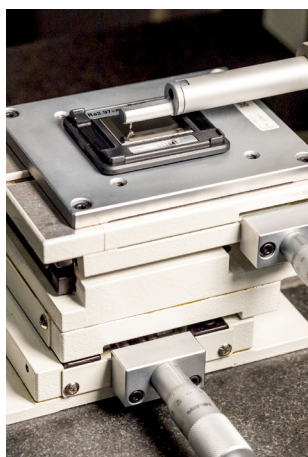
Exemple d'étalonnage du stylet
