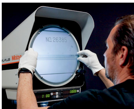
Exemple de mesure de la précision de projection.
