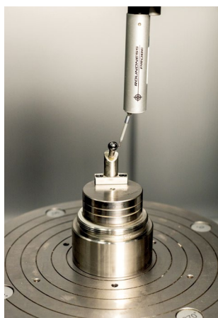
Exemple d'étalonnage du stylet
