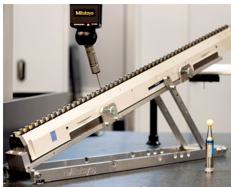
Exemple de mesure sur cale à gradin
