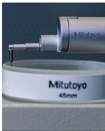
Exemple d'étalonnage du stylet
