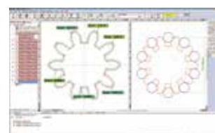
Esempio di corrispondenza del profilo dell'ingranaggio con l'analisi del diametro eccedente
