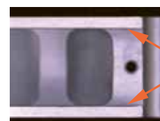
Misura dei bordi di un pezzo a gradini (modalità ad alta risoluzione)
