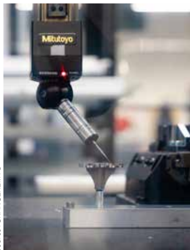
Palpeur de la MiSTAR 555 en action sur une embase de prothèse de genou
