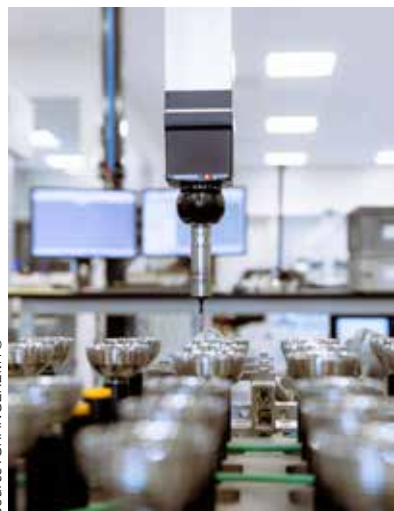
Lots de cupules soumises au contrôle final dans le laboratoire de métrologie d'Amplitude
